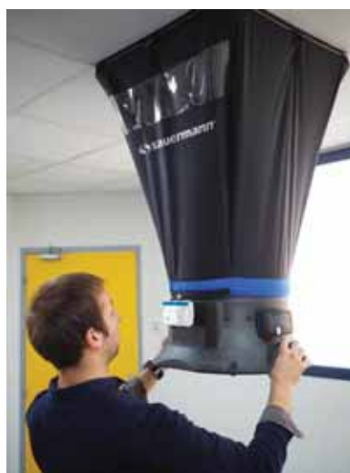
Colocación del caudalímetro
