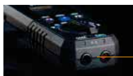
Entrada de cables de prueba
