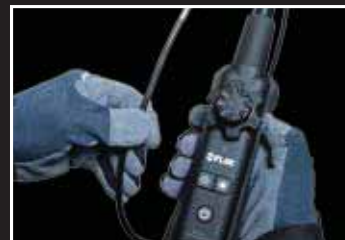
Sensor de cámara articulado con cables
