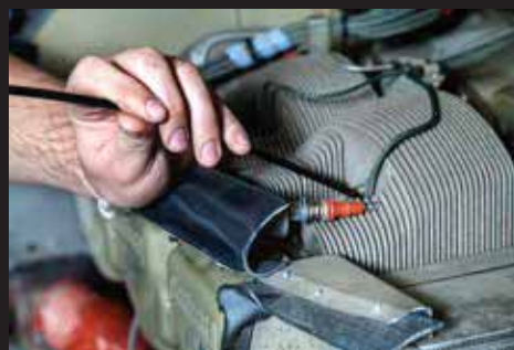
Inspección del cilindro del motor de la aeronave con VSA2-1M
